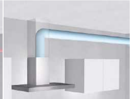
Beispiel einer guten Verrohrung
