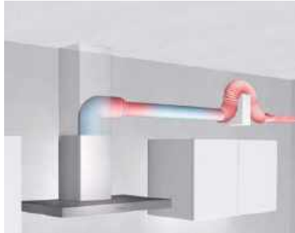
Beispiel einer schlechten Verrohrung
