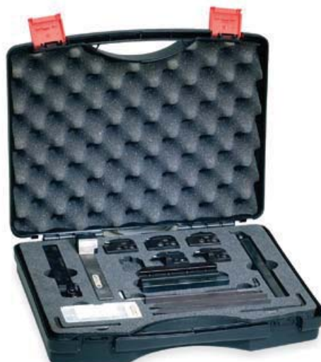
K Schaumstoffeinatz gefräst, Produktnester mit unterschiedlichen Höhen. Als Gegenlager ist im Deckel ein Noppenschaumstoff eingeklebt.
