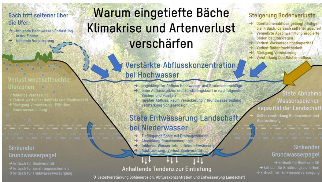
Abbildung 3: Problemfelder und Prozesse eingetiefter Bachsohlen (© Emch+Berger AG Bern).
