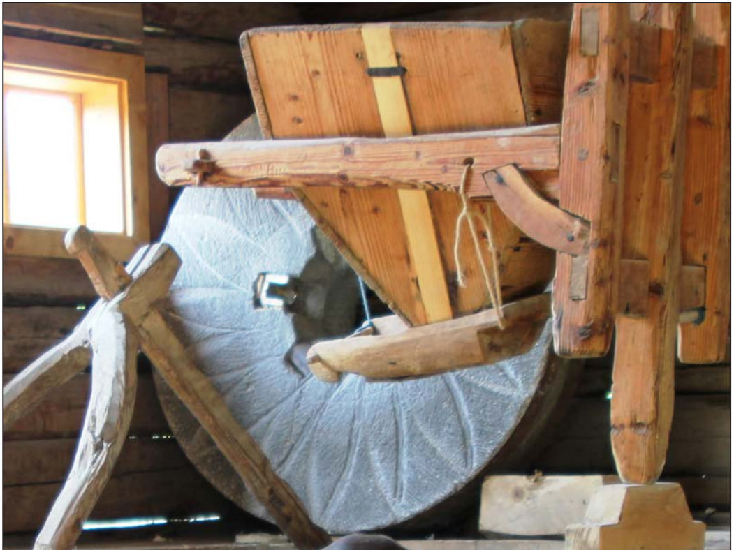
8. kép. Újravágott malomkő őrlő felülete
