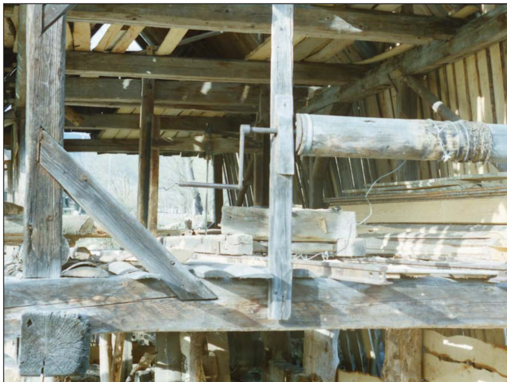
9. kép. Emberi erővel működtetett csörlős előtolás (húzás)
