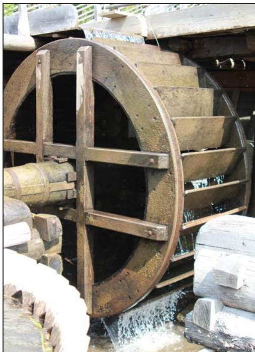
6. kép. A felülcsapós vízkerék felépítése
