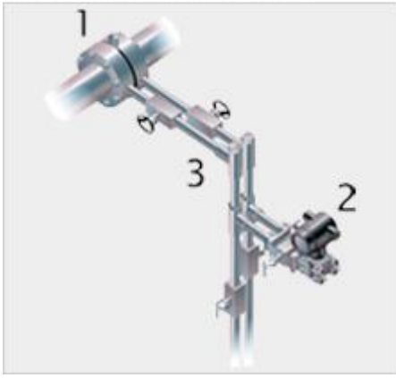
图 1.6. a - 传统的差压流量安装包括独立的一次元件、二次元件和第三方元件。
