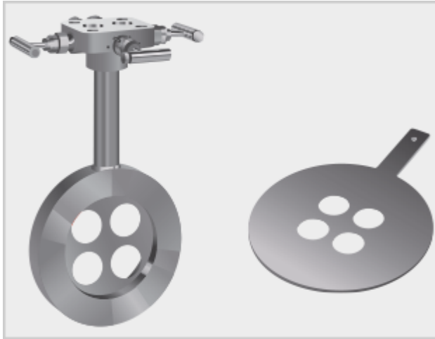
图 3.7.c - 该示意图显示了罗斯蒙特调整型孔板上的四个孔如何调节不规则流动剖面，以使短直管能够准确测量流量。
