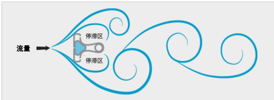
图 3.8. c - 罗斯蒙特阿牛巴传感器的涡流脱离示意图。罗斯蒙特阿牛巴 T 形设计的上游表面平整，从而形成固定分离点，相比于其他 APT 传感器设计，这可在较大流量范围内提高性能并稳定低压测量。
