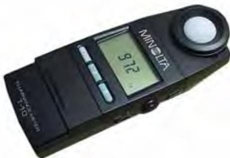
■ Die gemessene Beleuchtungsstärke kann mit den entsprechenden Werten der Norm SIA 380/4 (Elektrische Energie im Hochbau) verglichen werden.
