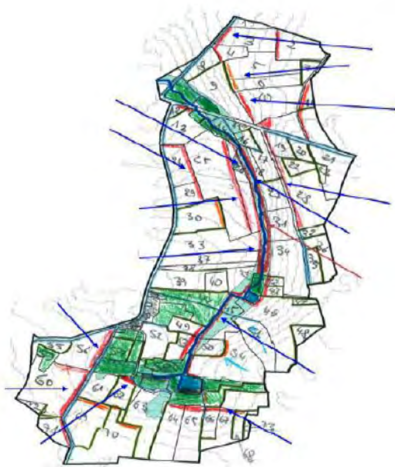
Esempio di mappa di campo con l'indicazione degli appezzamenti, dei corpi idrici superficiali con la direzione dei flussi d'acqua (frecche blu), delle strutture di mitigazione esistenti (verde) e delle misure di mitigazione proposte (rosso).
