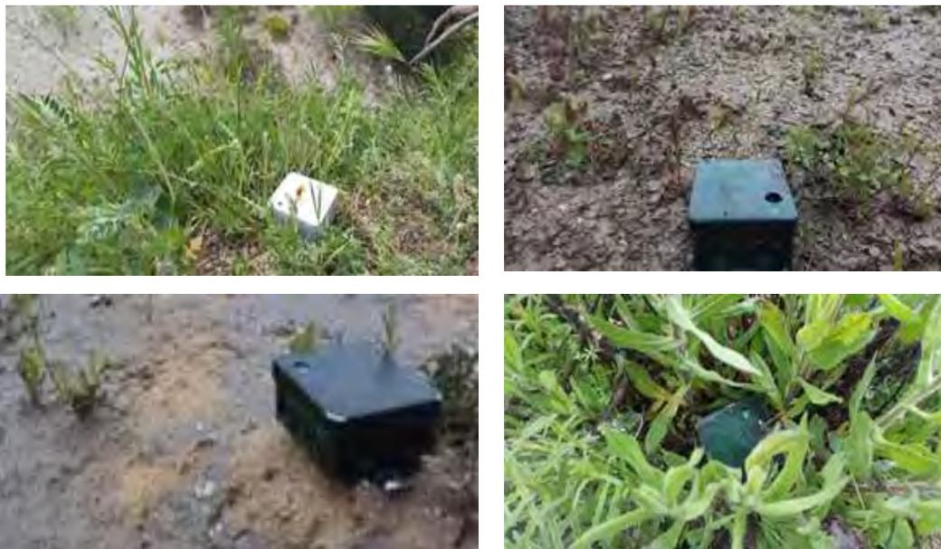
Figura 20. Los 4 detectores *Audiomoth* empleados para el registro acústico de los quirópteros.
