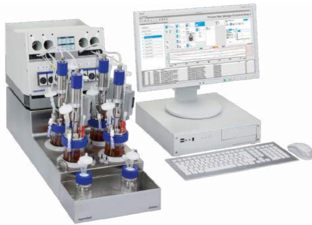
DASbox® Mini-Bioreaktorsystem 60 - 250 mL Arbeitsvolumen (autoklavierbar) 65 - 250 mL Arbeitsvolumen (Einweg)
