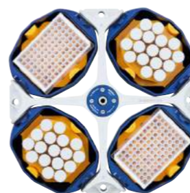
Universaladapter 1 Konfiguration für Deepwell Plates und Eppendorf®-Gefäße 5 mL.
