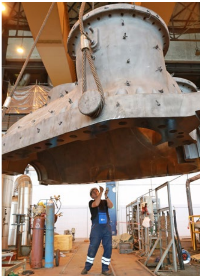
Равнање површина поклопца турбине средњег притиска
