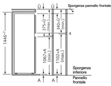
Le misure della porta del mobile qui indicate sono valide per un interspazio fra le prote di 4 mm. In caso diverso (max 14mm), le misure devono essere sdattate.
