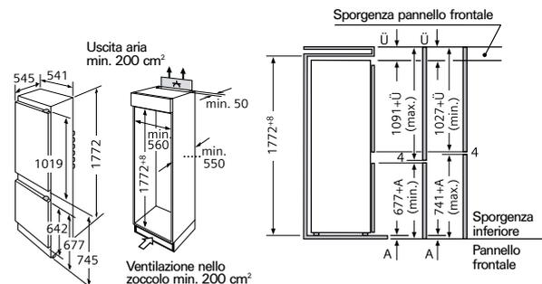
Le misure della porta del mobile qui indicate sono valide per un interspazio fra le porte di 4 mm. In caso diverso (max 14mm), le misure devono essere adattate.
