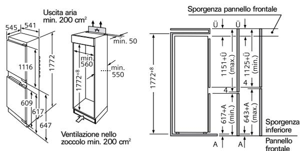
Le misure della porta del mobile qui indicate sono valide per un interspazio fra le porte di 4 mm. In caso diverso (max 14mm), le misure devono essere adattate.
