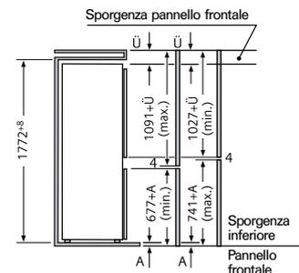
Le misure della porta del mobile qui indicate sono valide per un interspazio fra le prote di 4 mm. In caso diverso (max 14mm), le misure devono essere adattate.
