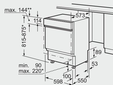
\*\* Pannello in acciaio inox fino a max. 143mm
