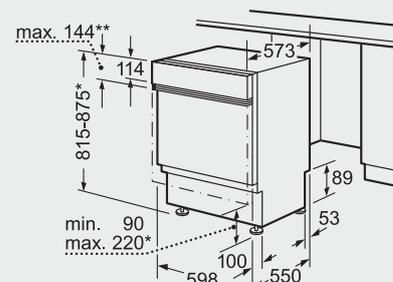
\*\* Pannello in acciaio inox fino a max. 143mm
