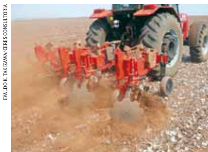
Destruidor de touceiras de algodoeiro acoplado na base de tração do trator
