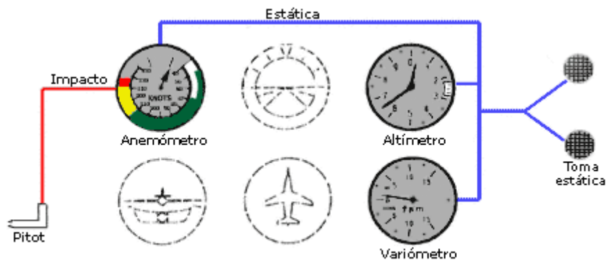
Fig.2.2.2 - Sistema de pitot y estática.
