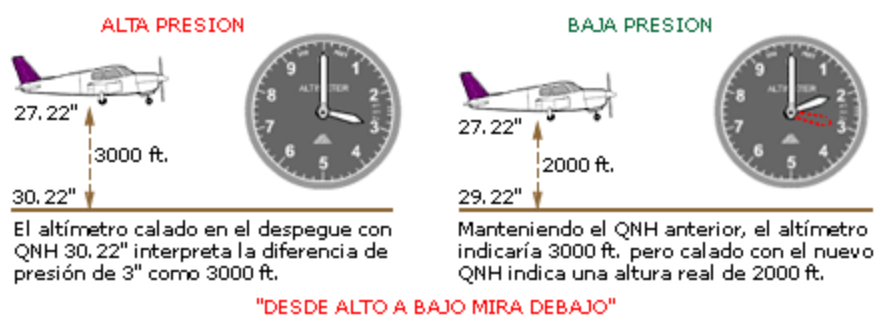
Fig.2.3.5 - Ajuste del altímetro a los cambios QNH en distintas áreas.
