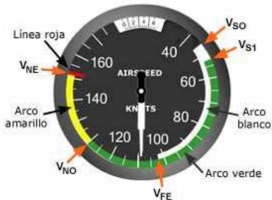
Fig.2.5.7 - Códigos de colores en anemómetro.
