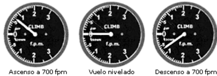
Fig.2.4.3 - Indicaciones del variómetro.
