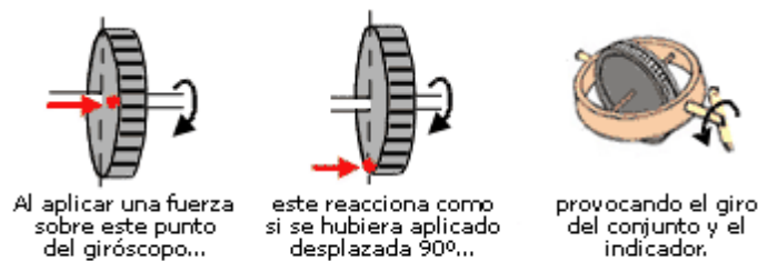
Fig.2.8.4 - Funcionamiento del indicador de viraje.
