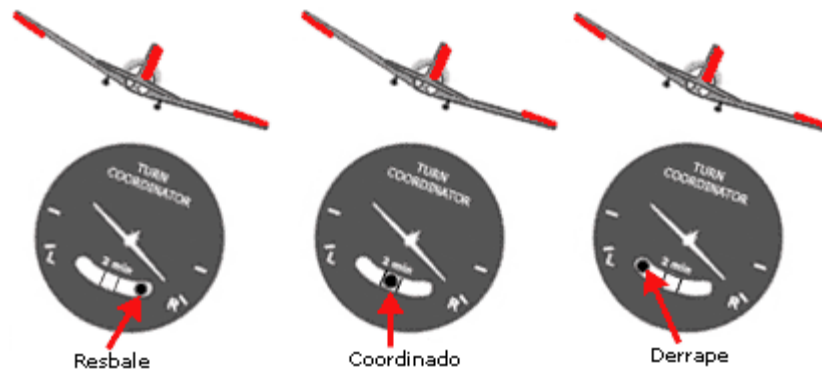
Fig.2.8.7 - La "bola" indica la calidad del viraje.
