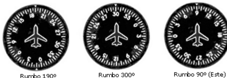
Fig.2.7.3 - Lectura del indicador de dirección.
