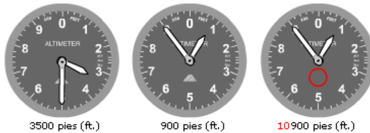
Fig.2.3.3 - Lectura del altímetro de dos agujas.
