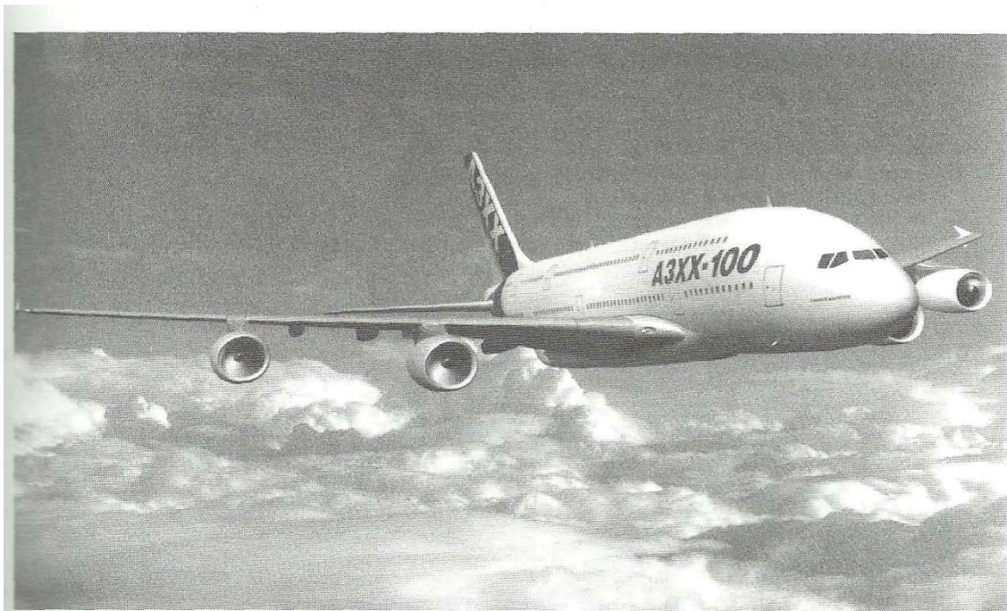
Airbus A-380, en la ilustración aún como A3XX-100, es el primer reactor comercial con fuselaje de doble piso continuo. Cortesía de Airbus Industrie
