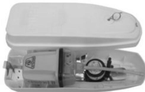
Se trata de un transmisor de radio flotante, activada por baterías y que, al existir siniestro, se debe activar automáticamente o de forma manual. La mayoría de modelos llevan una luz piloto que avisa de su activación y, con frecuencia, también del estado de las baterías. Transmiten automáticamente en la frecuencia de 406 MHz sin necesidad de que intervenga ningún operador y, simultáneamente, en la frecuencia 121,5 MHz para búsqueda y salvamento SAR.
