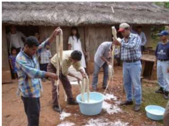
Figura 2. Proceso de remojado de la fibra con agua y jabón (Fuente: Edouard y Le Moing, 2005).
