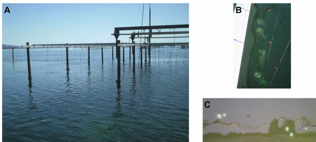
Figura 13. Estructura en la que se colocaron los dispositivos de muestreo pasivo en la laguna Thau (A). B) SPMDs utilizados para medir los compuestos orgánicos y C) los DGTs utilizados para la medición de los metales.
