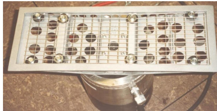
Bild 9.14+15 Nachbildung der Schadensursache am Schwingtisch [3]
