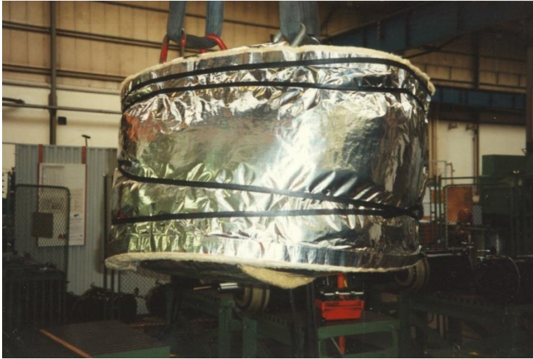
Bild 9.27 Versuch einer Schalldämmung mit Glaswolle [3]
