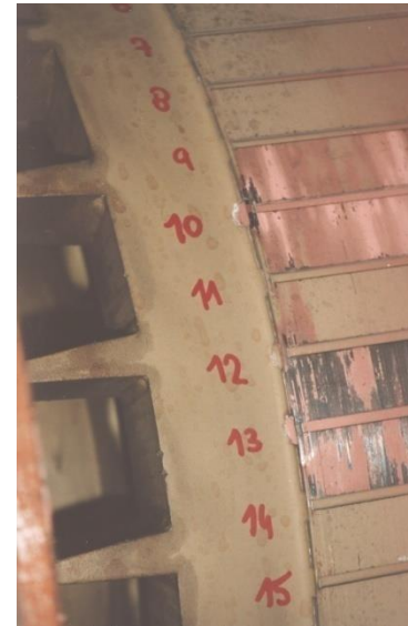
Bild 9.10+11 Risse bei KS-Stäben bei Übergang zum KS-Ring [3]
