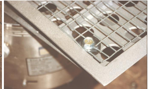
Bild 9.14+15 Nachbildung der Schadensursache am Schwingtisch [3]
