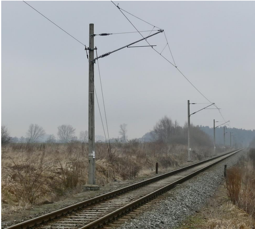
Bild 4.6 Einfachfahrleitung keine Schwingungsdämpfung kostengünstiger
