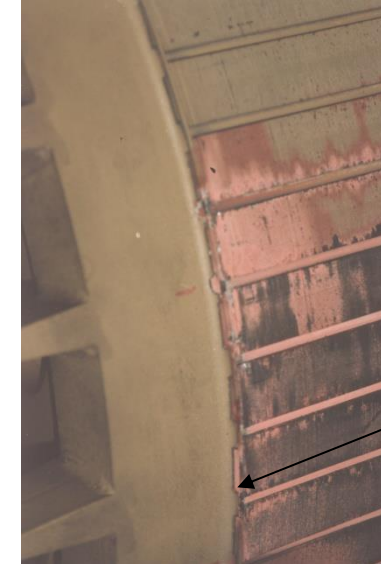
Bild 9.10+11 Risse bei KS-Stäben bei Übergang zum KS-Ring [3]
