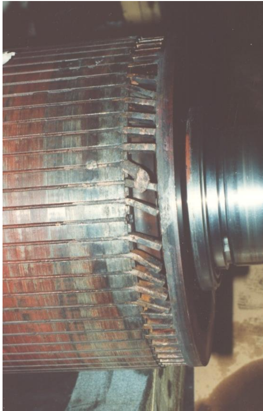
Bild 9.6 KS- Stäbe Bruch und Risse [3]
