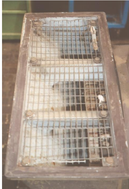
Bild 9.12 Lüftungsgitter am BS-Lagerschild mit abgebrochenen Gitterdrähten [3]
