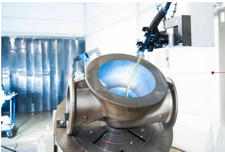
Automatisiertes Schweißen im Inneren von Rohren mit extra langem Brennerhals
