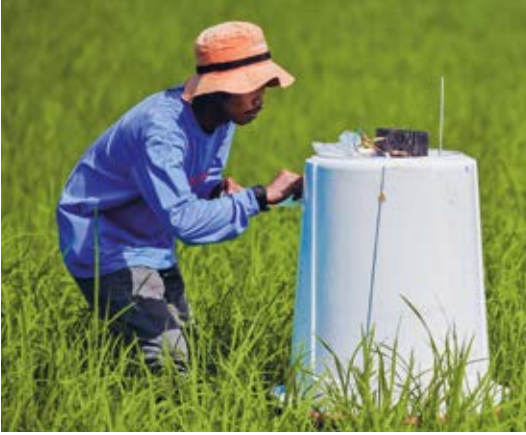
Links: In geschlossenen Kammern können die Methanemissionen der Reisfelder gemessen werden. Regelmäßige Luftproben geben darüber Aufschluss, wie stark sich das Klimagas in der Kammer anreichert. Rechts: Dr. Björn Ole Sander vom «International Rice Research Institute», Hanoi * Fotos: Isagani Serrano / IRRI
