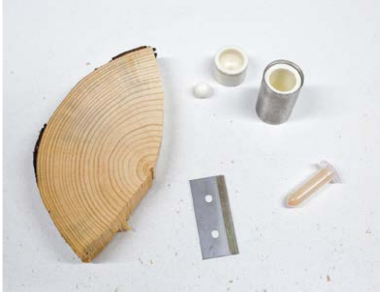
Das Holz verschiedener Jahresringe wird in einem Behälter unter Beigabe einer Kugel zermahlen und anschließend analysiert. Foto: Nora Klein
