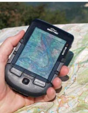
Hochwertige topografische Karten aufs GPS-Gerät bringen – das macht das Satmap Active 10 schnell und einfach möglich: SD-Kartenchip ins Gerät stecken, fertig. Der große
