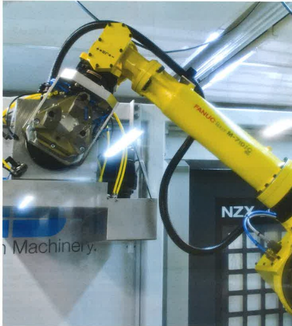
Automation Plus: Der Handlingroboter führt ein Werkstück zu einer inhouse gebauten Ausblasvorrichtung
