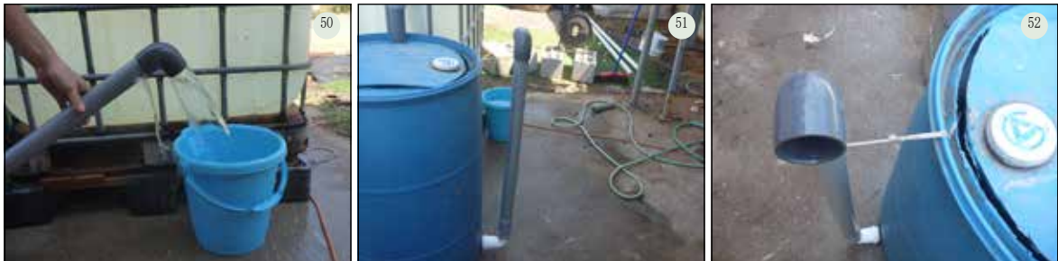
机械分离器的排水检查（图50-52）。
