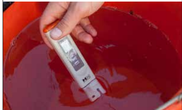
图3.10 使用数字酸碱仪检测水中的pH值
