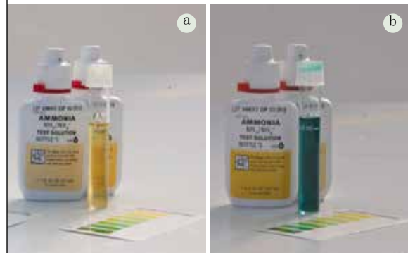
图5.6 能显示低氨水平（0-0.5毫克/升）（a）和高氨水平（4毫克/升）（b）的水质测试盒
