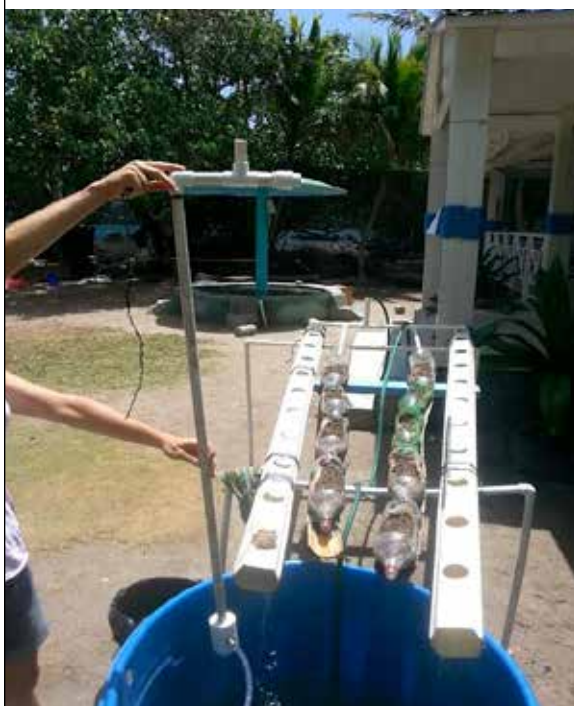
图4.42 简易的气提水泵
