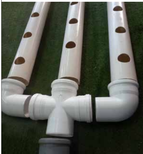
图4.64 几根显示孔间距的栽培管
