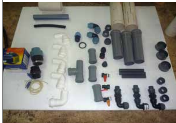
图4.48 常用的管道安装配件
