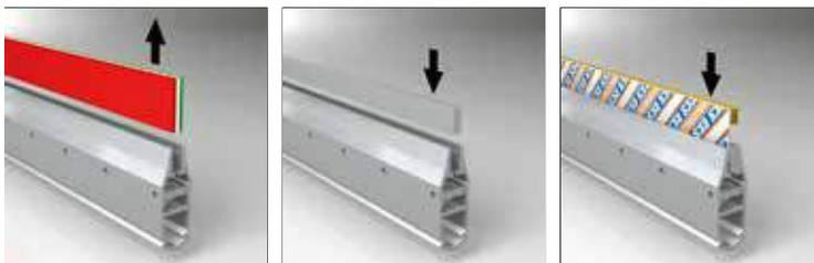
Standardrakel entfernen    Stützleiste einsetzen    Systemrakel einsetzen
