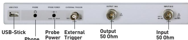
Abb. 10.1: Anschlüsse Geräte-Vorderseite
