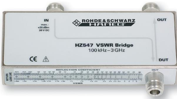
Abb. 13.2: VSWR-Messbrücke HZ547 für HMS1010/3010
