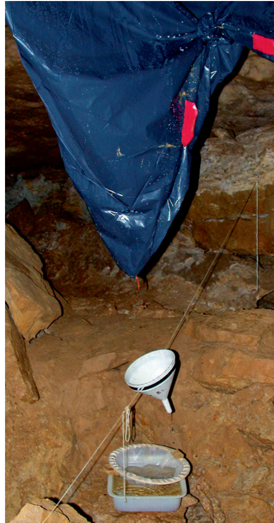
Raccolta di organismi stigobi mediante captazione e filtraggio delle acque di stillicidio
