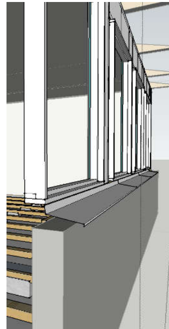
Mynd 21: Teikning sýnir áfellur yfir steinvegg að
