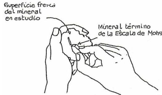
Figura 5 – Prueba de dureza
