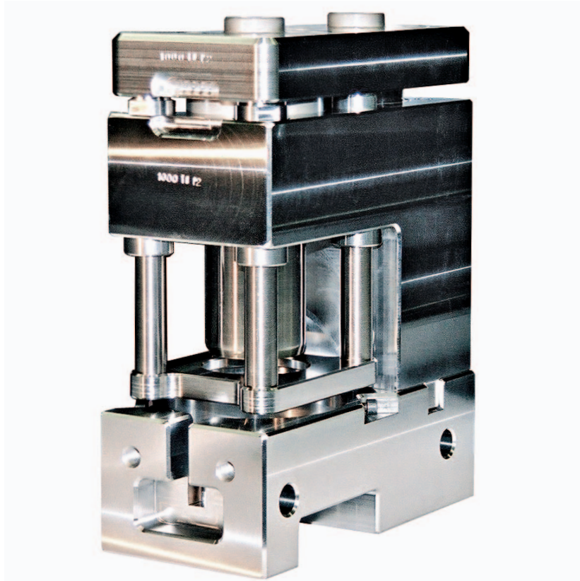
Abgratwerkzeug als schnellwechselbares Modul mit Werkzeug-Rund-Rund-Säulenführung und mechanischem Gratabstreifer, Abgratwerkzeugoberteil in Position: „Pressenstößel unten“ (Ansicht von vorne-links-oben)
