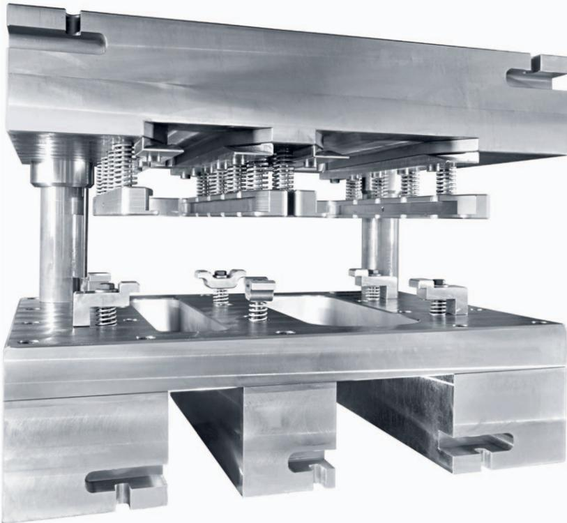
2-Stationen-Abgratwerkzeug mit Werkzeug-Rund-Rund-Säulenführung und mechanischem Gratabstreifer, Abgratwerkzeugoberteil in Position: „Pressenstößel oben“ (Ansicht von vorne)
