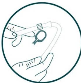
11. Limpiar el puerto y despinzar el tubo de drenaje
