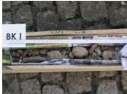
Abb. 2: Bohrkern mit Injektionsmörtel an Grenzflächenbereich
