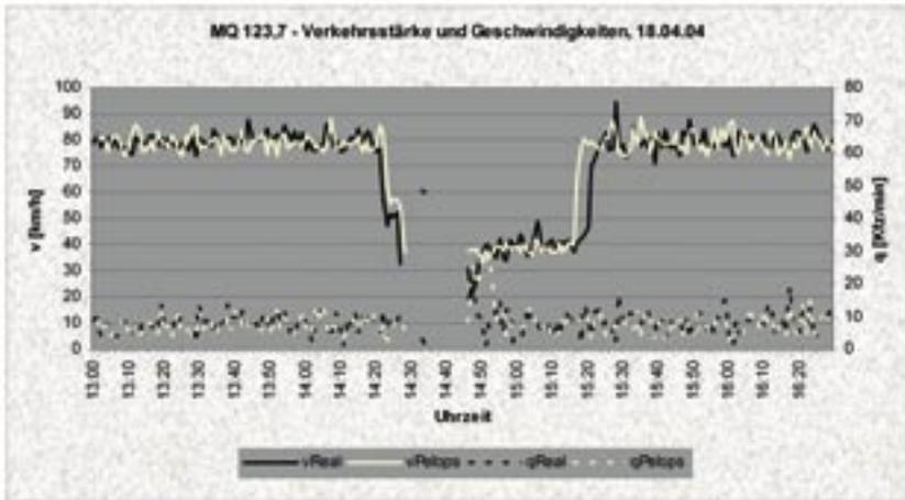
Abbildung 1: Beispiel für das Simulationsergebnis eines Messquerschnittes auf der A71 im Tunnel Hochwald
