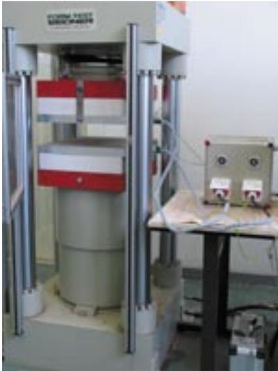
Abb. 1: Laborpresse zur Plattenherstellung
