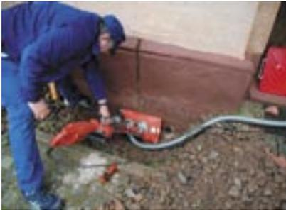
Abb. 3: Probenahme Kernbohrung
