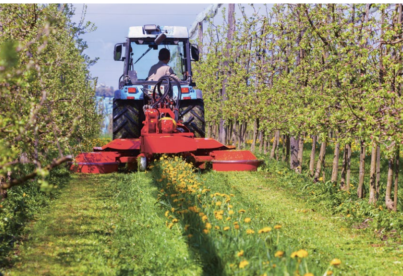
Les broyeurs adaptés à l'entretien des bandes fleuries (sur la photo: modèle Humus OMB® avec décharge latérale) permettent un entretien efficace des interlignes tout en épargnant les plantes des bandes fleuries.
