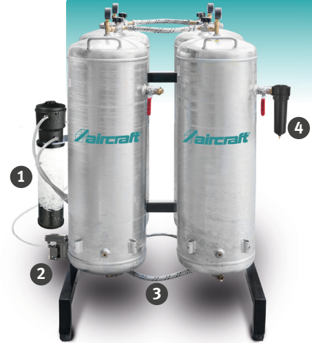
Abb. zeigt KB 4x100/10 Zubehör (1) Kondensataufbereiter mit Zuleitung, (2) automatische Kondensatableiter mit (3) flexiblen Leitungen als Zuleitungen und (4) Feinfilter
