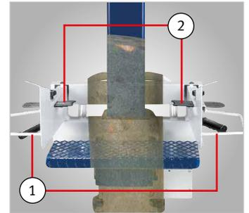
Eine hohe Betriebssicherheit wird durch die Zwei-Hand-Sicherheitsschaltung, den Handschutz (1) und die verstellbare Holzhaltervorrichtung (2) an jedem Bedienarm gewährleistet.
