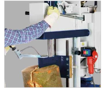
Der verschweißte Spaltkeil ist mit einer austauschbaren Messingführung ausgestattet. Die Führung wird über einen integrierten Schmiernippel gewartet.
