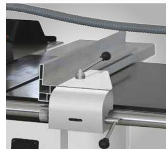
Großer Aluminium-Parallelanschlag auf Rundstangenführung mit Feineinstellung
