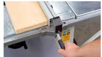
Der große Aluminium Parallelanschlag mit Exzenter-Schnellspannung kann per Skala präzise und leicht eingestellt werden.
