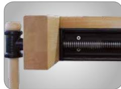
Massive Linearführung an der Hinterzange
