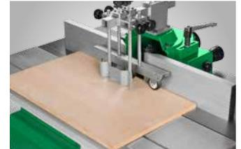
Fräsanschlag mit feineinstellbaren Aluminium-Anschlägen
