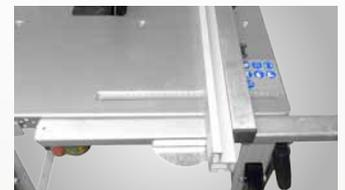
Leichte und präzise Einstellung des Parallelanschlages mit Exzenter-Schnellspannung per Skala
