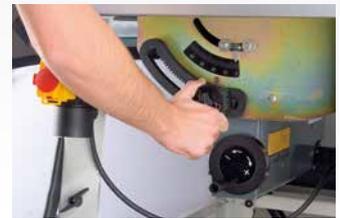
Sägeblattschwenkung von 0° bis 45°, präzise und gradgenau, erfolgt über Handrad und Skala
