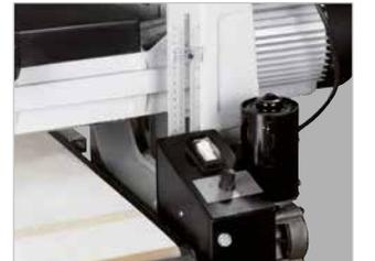
Höhenverstellung der Schleifeinheit an einer Skala ablesbar
