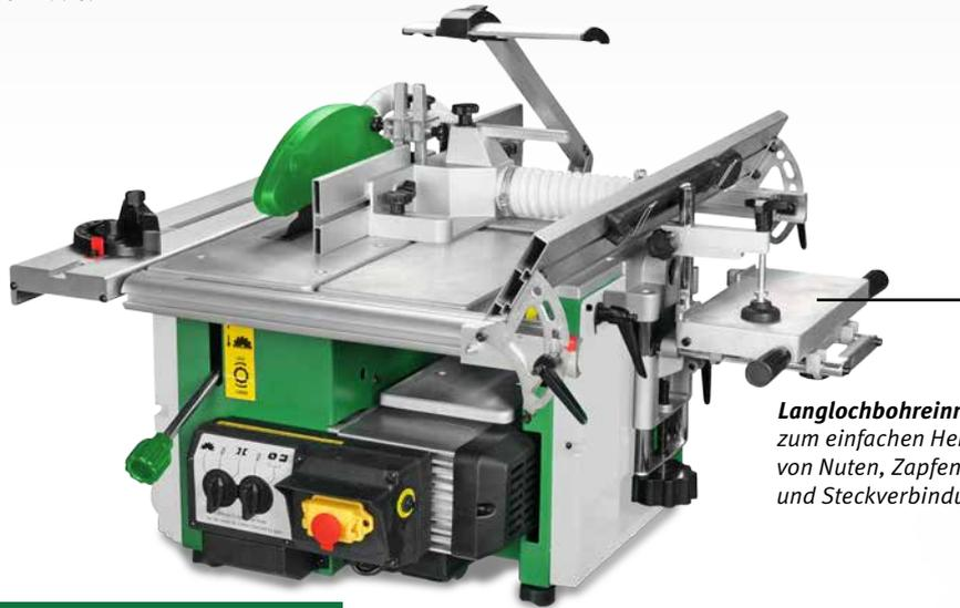
**Langlochbohrereinrichtung** zum einfachen Herstellen von Nuten, Zapfenlöchern und Steckverbindungen
