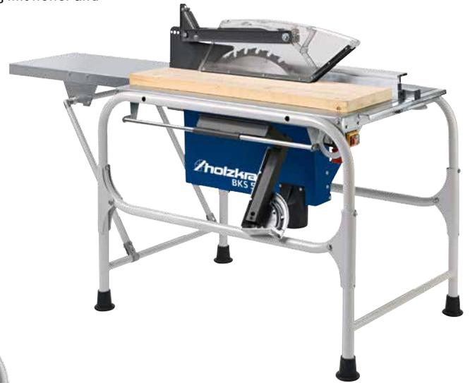
Winkelverstellbare Querschneidvorrichtung mit Keilschneidlehre, abklappbar
