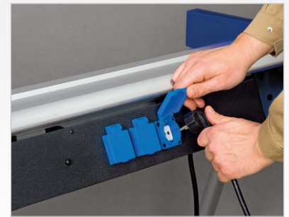
Drei integrierte 230 V Steckdosen auf der Bedienerseite.
