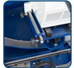
• mit präziser Linearführung mit Schmiernippel
