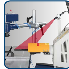
• optionale Laser-einrichtung zum Markieren der Bohrstellen
