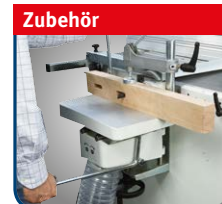
Option Langlochbohrereinrichtung mit Wescott-Bohrfutter 0-16 mm
