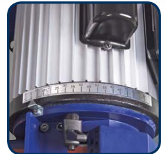
Schleifarmschwenkung über Klemmschraube und Skala von 0 - 90°
