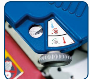
Der Einstellknopf für die Klebermenge befindet sich an der Oberseite
