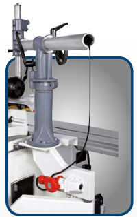
Optional ** · Schwenkarm mit Steckdose zur Anbringung eines Vorschubapparates · Art.-Nr.: 5510510 475,00 € zzgl. MwSt.
