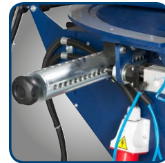
• Dübeleinrichtung mit verstellbarer Rasterteilung 16 / 22 / 25 / 32 serienmäßig
