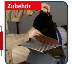
Schleifvorrichtung zum Schleifen von Rundungen mit schwenkbarem Arbeitstisch
