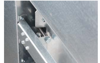
Mit verbesserter Arretierung der Späne Kästen
