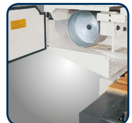
250 mm große gewuchtete Bandlaufrollen sorgen für optimalen Antrieb.
