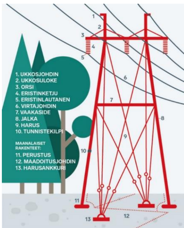
Kuva 6. Pylvään tekniset rakenteet.
