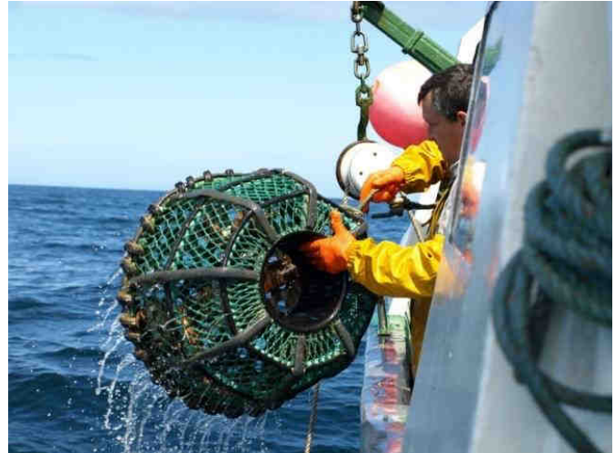
Le Galathée, caseyeur exclusif, virant ses filières à l'aide d'un treuil vire-casier (Photo : S. Lecerf)
