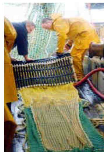
Grille de 13 mm, mailles carrées langoustine (devant), mailles carrées merlu (au fond). (Photo : L. Flageul)
