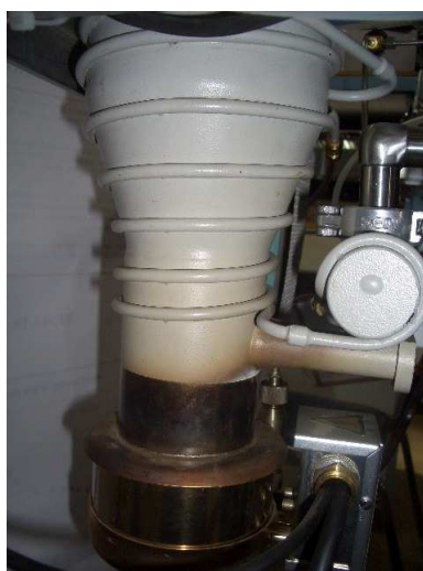
Figura 5.4: Bomba Difusora del sistema experimental, muestra la circulación del agua para enfriar y condensar
