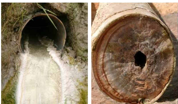
Fig. 1 - Nei condotti, le acque supersature di carbonato di calcio depongono calcite fino ad ostruirli.
