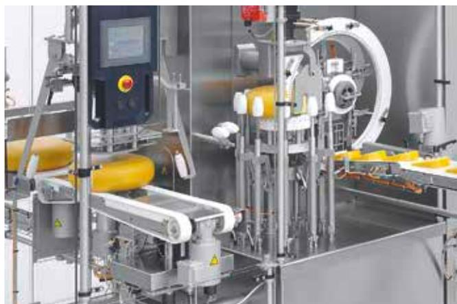
*Hygienische Herstellung am Beispiel der Portionierung von Käse: Hier werden ganze Käselaike der Maschine zugeführt und entsprechend in die aus dem Handel bekannten Scheiben geschnitten.*
