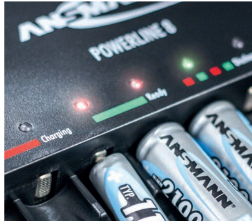
Einzel-schachtüberwachung Individual cell supervision
