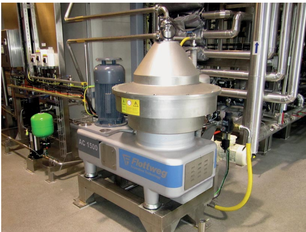
CENTRIFUGA DE DISCOS FLOTTWEG AC 1500 para la purificación del aceite
