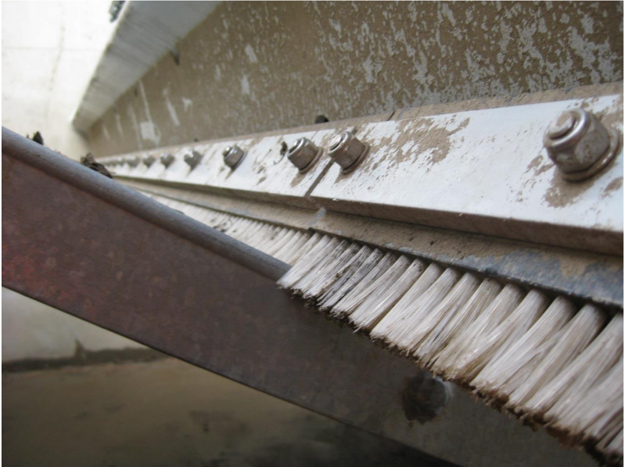
Abbildung 12: Detail Rechenreiniger mit Reinigungsleiste und Bürsten
