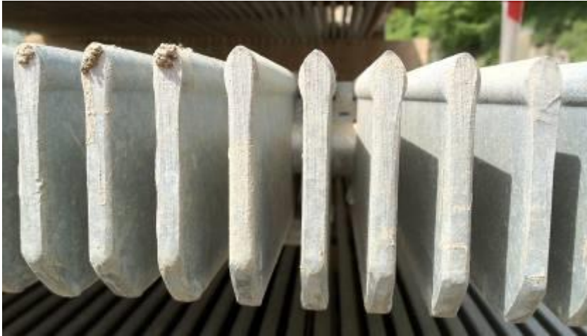
Abbildung 6: Feinrechenprofil in Tropfenform der Maschine 1
