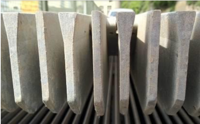
Abbildung 8: Feinrechenprofil in Y-Form und Flachstählen der Maschine 3
