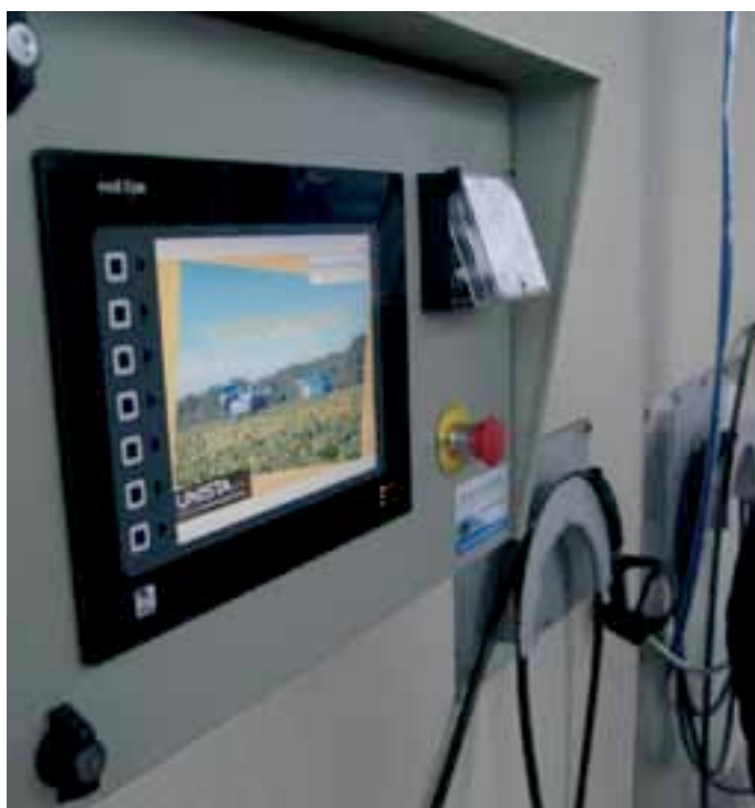
L'ensemble des opérations est contrôlé depuis un boîtier dans lequel chaque utilisateur insère sa carte. Il reçoit en fin de processus un ticket précisant les quantités récupérées.
