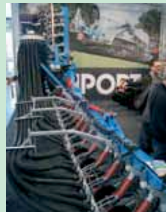
Cet enfouisseur Duport de 12,30 m répond aux exigences du trafic contrôlé.
