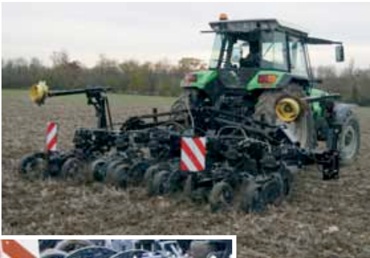
Le strip-till fait gagner en temps plus qu'en souplesse d'intervention. Il faut rester vigilant quant à l'humidité du sol, car tout lissage s'avèrera préjudiciable. Au printemps, il peut être préférable de travailler sans dent de fissuration (ici un modèle Dawn Pluribus doté de disques gaufrés).
