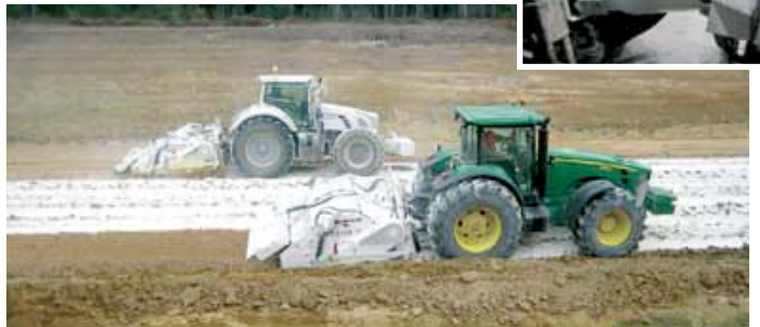
Pour les malaxeurs (stabilisatrices de sol) ou broyeurs, la seule solution semble en revanche de concevoir un carter de protection. Fabriqué par l'entrepreneur, il présente parfois plusieurs inconvénients, dont celui de compliquer l'accès aux graisseurs.
