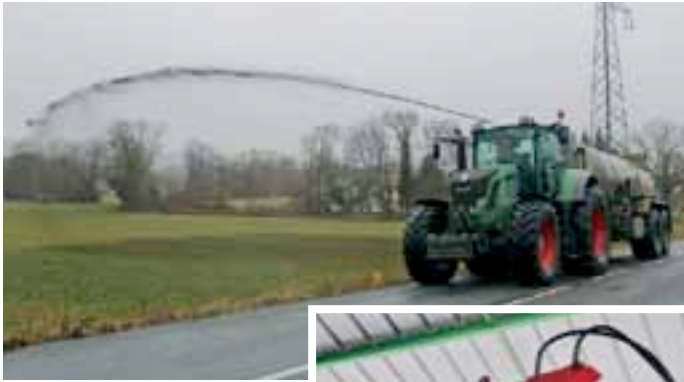
Des canons d'épandage équipent toutes les tonnes à lisier. Ils permettent d'épandre depuis la route, jusqu'à 100 mètres de distance. Une solution pour continuer les chantiers, même lorsque le beau temps n'est pas au rendez-vous.
