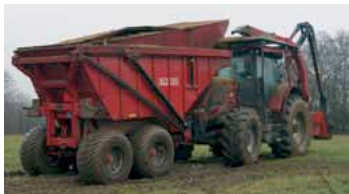
L'ensemble composé d'un tracteur Valtra S 263, d'une déchiqueteuse à grue FSI TP 400, et d'une remorque élévatrice de 15 m 3 , travaille de façon autonome. Pour autant, il n'épargne de la mise en place d'une organisation de chantier rigoureuse.
