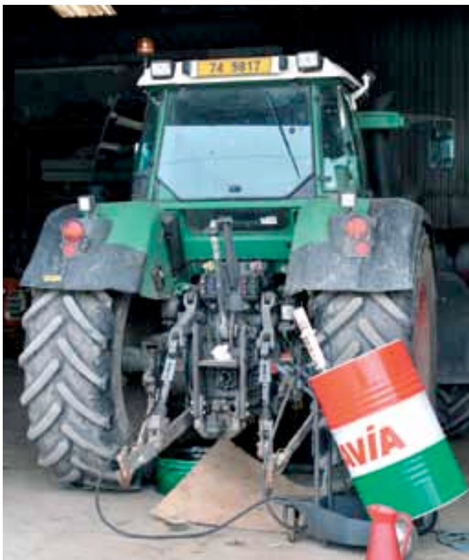
Dans l'atelier (chauffé !) de la Setar Bibollet, c'est l'heure de la vidange pour le pont arrière de ce tracteur Fendt.
