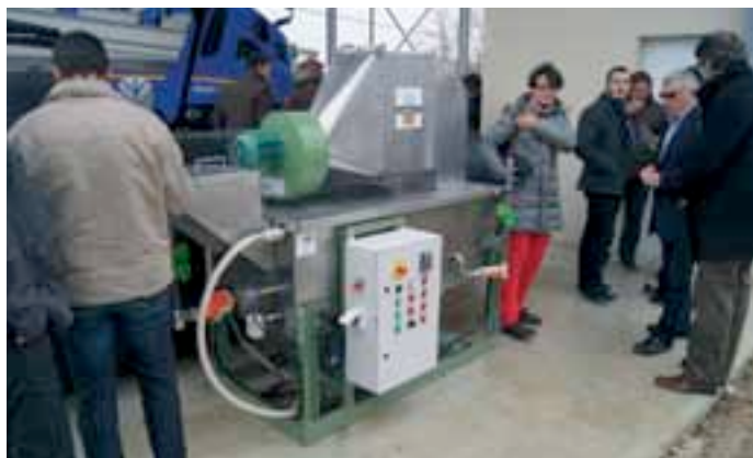
L'Evapophyt traite les effluents phytosanitaires par évaporation forcée. La quantité de déchets qui doit ensuite être retraitée, correspond à un millième du volume initial.
