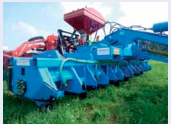
Le strip-till s'envisage sous différentes formes : au printemps ou à l'automne, en combiné ou décomposé, avec un outil à dents fissuratrices, à disques ondulés ou encore à axe horizontal animé.
