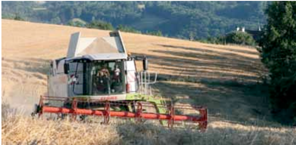
Les achats de matériel sont réfléchis pour répondre aux contraintes spécifiques des chantiers haut-savoyards. Ici, une moissonneuse équipée d'un système de correction de pente et de dévers, afin de garantir un débit de chantier optimal.
