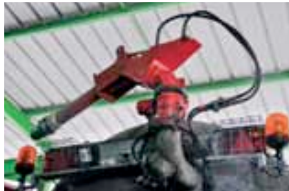
Des canons d'épandage équipent toutes les tonnes à lisier. Ils permettent d'épandre depuis la route, jusqu'à 100 mètres de distance. Une solution pour continuer les chantiers, même lorsque le beau temps n'est pas au rendez-vous.
