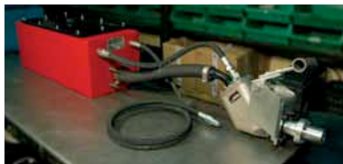
Remplacer le cardan par un kit d'entraînement hydraulique convient pour la majorité des bennes ou citernes d'arrosage. Plusieurs solutions adaptables existent sur le marché.
