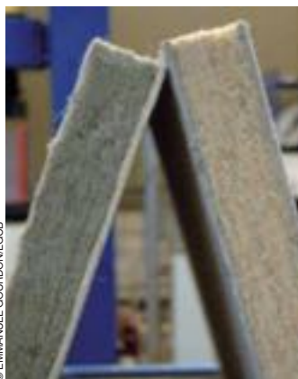
Échantillon de l'isolant en laine de chanvre posé en faux-plafond du magasin Auchan à Sens (Yonne).
