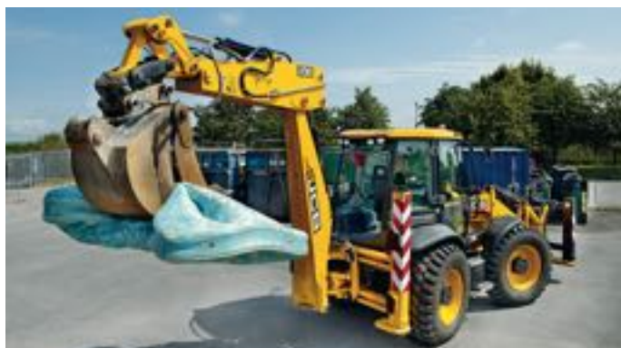
Le Seimat va créer une catégorie engins de manutention de déchets. Ici, pelle-pince JCB qui peut se soulever à hauteur d'un conteneur.
