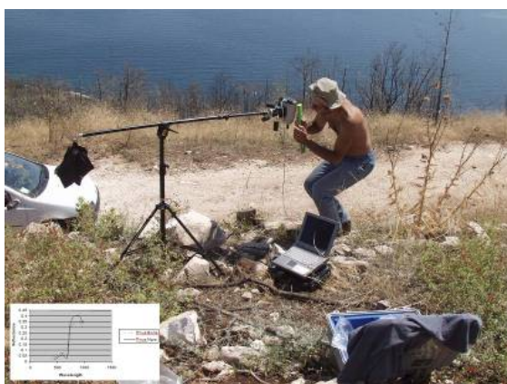
Συλλογή στοιχείων υπαίθρου με τη χρήση φασματοραδιόμετρου
