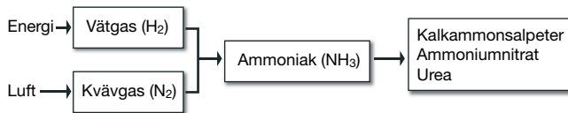
Figur 2. För att tillverka kvävegödselmedel som till exempel kalkammonsalpeter, ammoniumnitrat och urea behövs det vätgas och kvävgas. Kvävgas kan tas från vanlig luft, men vätgasen måste framställas, och det kräver energi.
